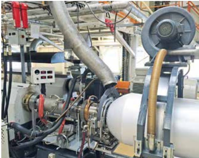
Bild 5. Noch leichterem Leichtschaum: P1-Kühlmischer bei der PS-Leichtschäumfolienherstellung verbessert die Zellstruktur und reduziert die Dichte (© Promix)
