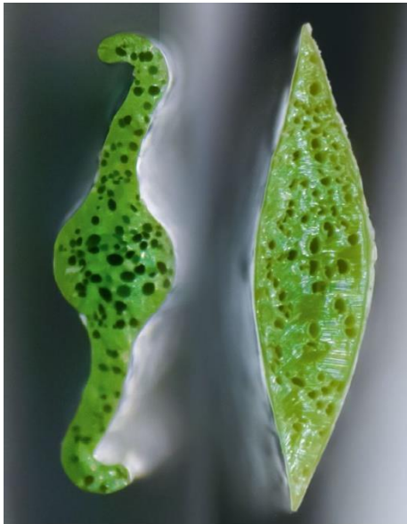
Links: Mikroskopische Darstellung der Mikrozellstruktur eines Grashalms im Querschnitt. Rechts: Kunstrasen Volume+
