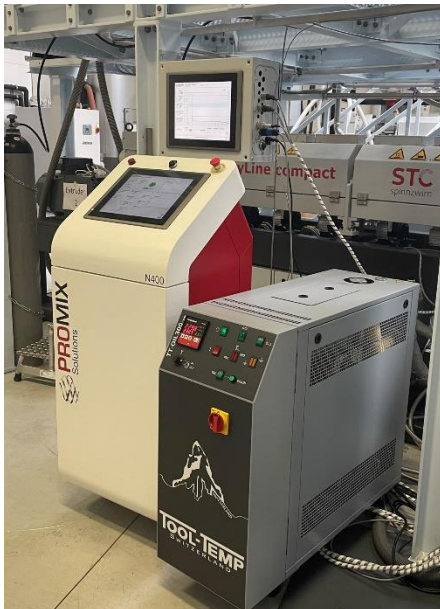
Faserextrusionsanlage von STC Spinnzwirn mit Promix Microcell Technology für voluminösere Kunstrasenfilamente
