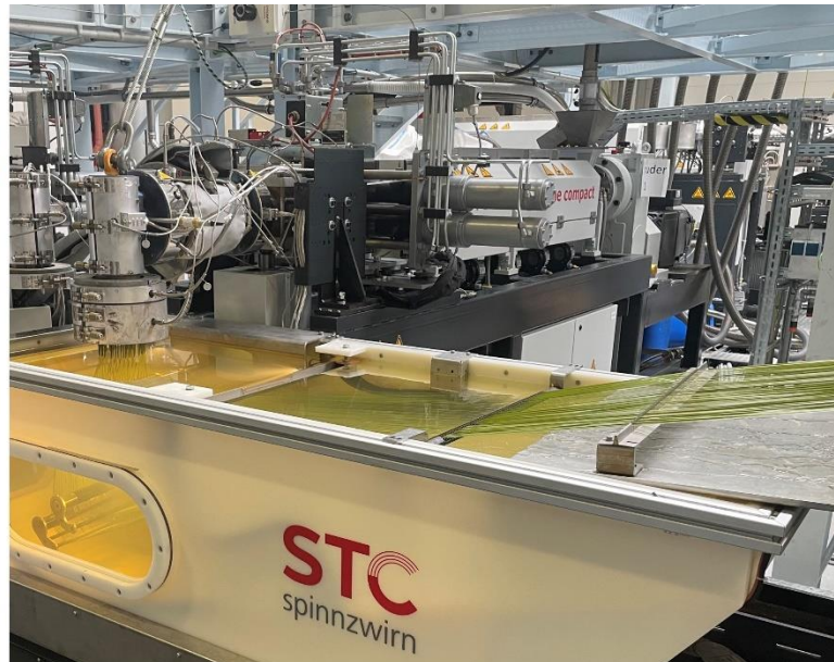
Faserextrusionsanlage von STC Spinnzwirn mit Promix Microcell Technology für voluminösere Kunstrasenfilamente
